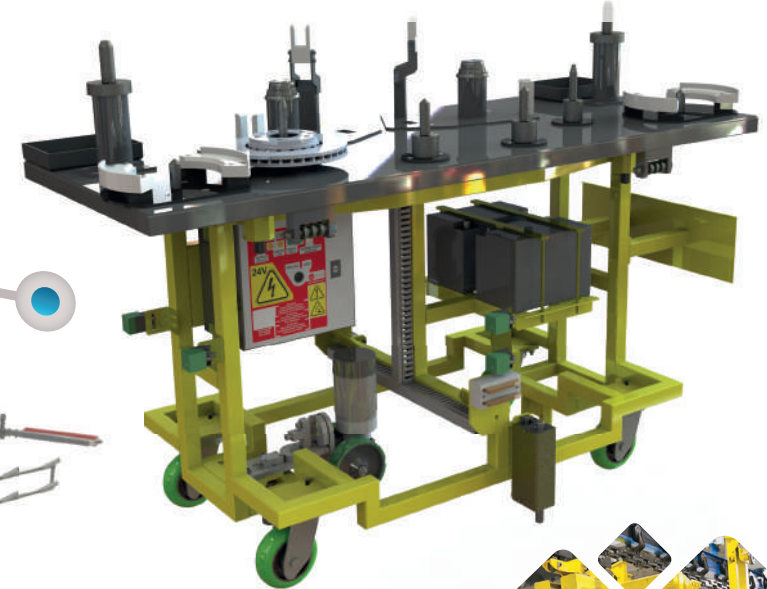
- Transportador de Discos de Freio e Cubos de Roda
